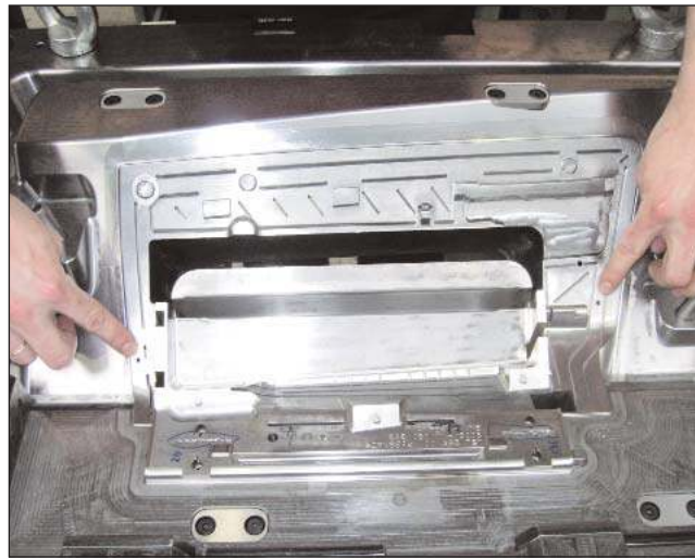
Anspritzpunkte im Werkzeug für den angussfreien Spritzguss
