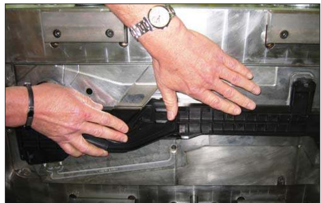
Beispiel: Lange Fließwege vom Anspritzpunkt zum Fließwegende: bis zu 1.000 mm
